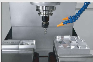
▲ V140 高速精銑加工 (AL7075) High speed & precision cutting
