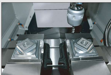
▲ V50 / V70 高速精銑加工 (AL7075) High speed & precision cutting
